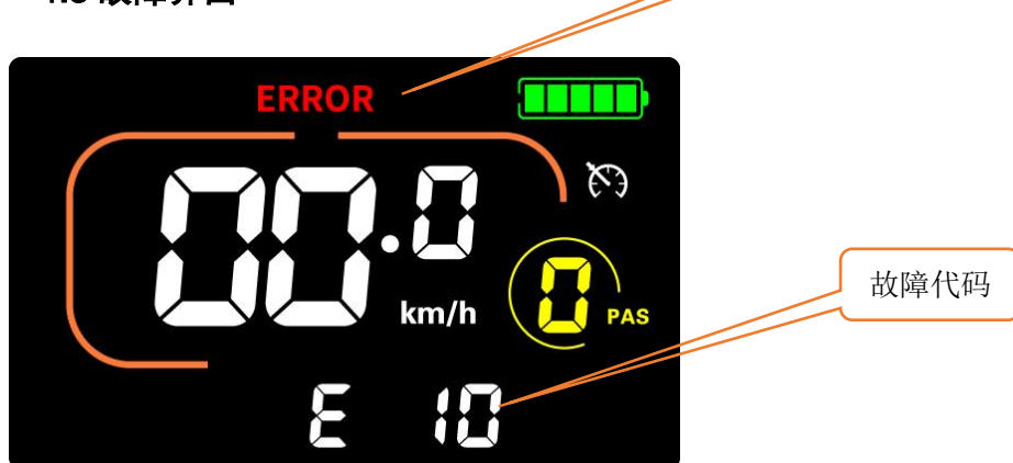
图示说明：故障：ERROR 标志，E10 表示故障代码
