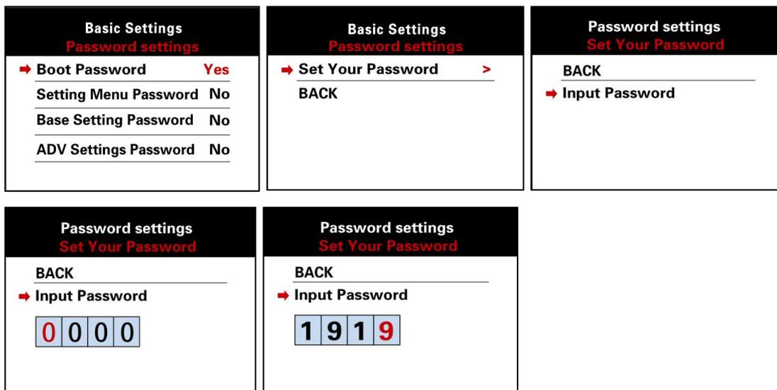
4.10 高级设置：Advanced settings 项，短按开关键进入Advanced Settings Password界面，按加/减键选择数字，完成后短按开关键切换至下一个数字，以此类推完成密码输入后短按开关键进入设置界面。
