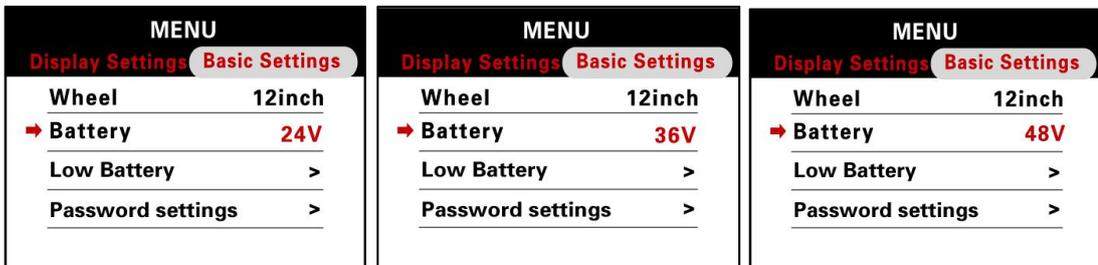
4.8 电池欠压设置: Low Battery, 可根据实际电池欠压点按加/减键调整仪表的欠压点。
