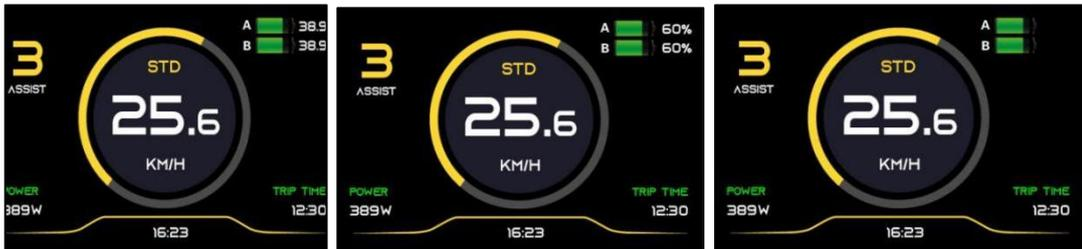
4.6 轮径选择: Wheel, 按加/减按键调整: 默认26inch, 精度0.1; 错误的轮径选择会导致速度异常。单位: 英寸inch
