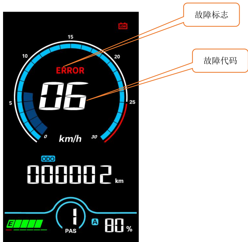
图示说明：故障：ERROR 标志，06 表示故障代码
